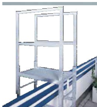
Attika-Überstieg 800 mm tief, mit Gitterrost, Stahl verzinkt, Abstiegsleiter, Ablängung bauseitig. Für den Abschluss am Abstieg empfehlen wir verstellbare Wandanker oder Fußplatten.
