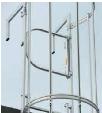
Sicherheitstüre 5) Nach DIN EN ISO14122. Automatisch schließend, Material Alu blank, Scharniere aus Edelstahl Artikelnr. 9663501
