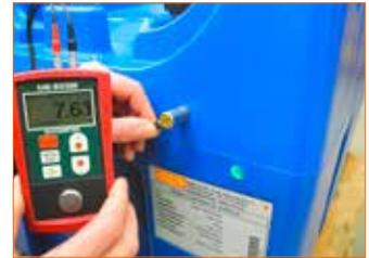
Wanddickenprüfung an einem PE Tank
